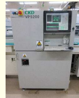
クリーム半田印刷後の 3D体積検査
