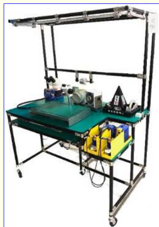
静電対策を施した 専用作業台
