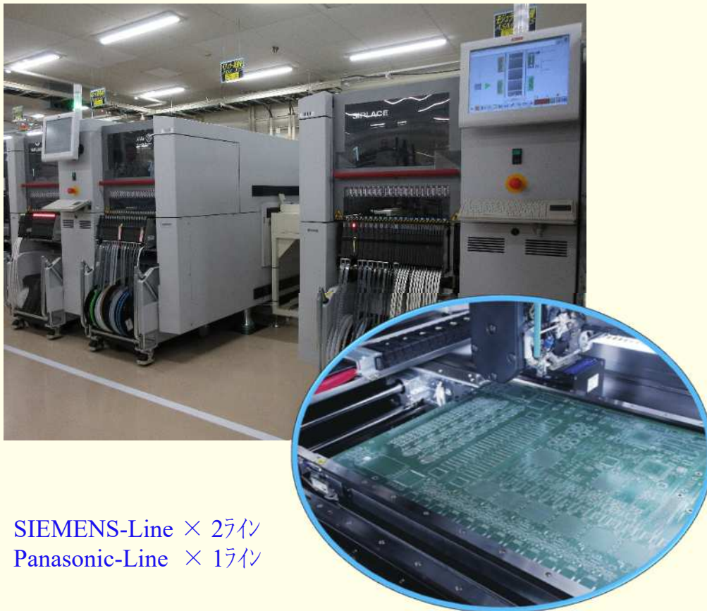
最新設備による高精度実装ライン
