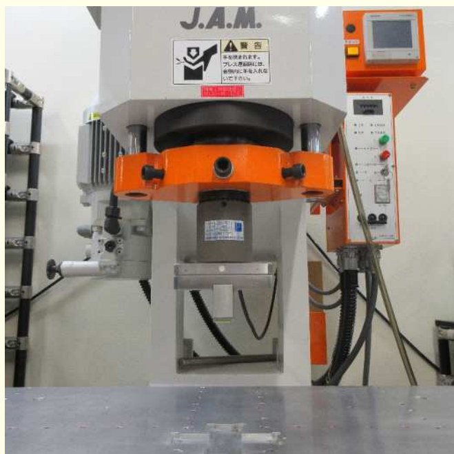
プレスフィット設備
